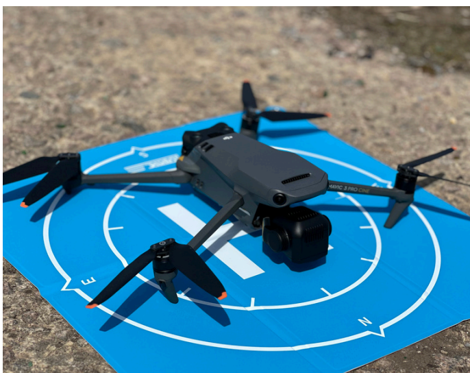
Ce drone permet de mener des enquêtes non techniques et d'identifier les zones dangereuses (août 2024).
