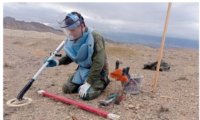
Ein Minenräumer der FSD sucht mit seinem Detektor sorgfältig nach Signalen, die auf vergrabene Sprengkörper hinweisen. (Tadschikistan, Oktober 2024)
